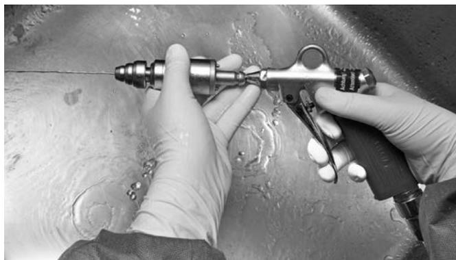
**6. Inspección visual del aparato.** Inspeccione la presencia de suciedad visible en las canulaciones, anclajes, etc. Repita los pasos 1 a 6 hasta que no quede ningún resto visible de suciedad.
