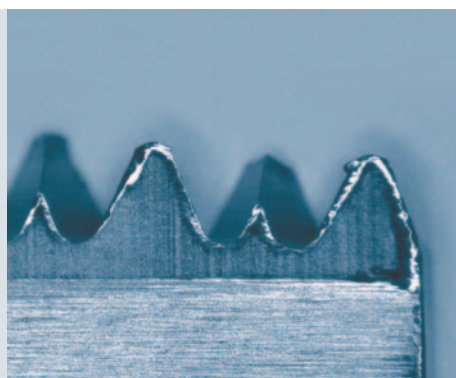
Imagen microscópica de una hoja de sierra usada: puede apreciarse la presencia de residuos y el desgaste mecánico
